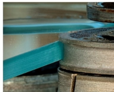
Kantenbearbeitung mit einer STAR TRACK Flat & Arris Schleifscheibe
