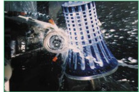
Die Bearbeitung von Hohlglas mit Diamant
